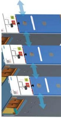
DF-2 系统是一个建立在“积木”原则上的模块化概念，这意味着开关柜生产是系列化的。因此模块化的DF-2 概念满足理性上、经济上的最高技术标准。机构的组合没有限制。非常复杂的电力一次图和变压器开关设备图都能通过这个广泛模块化单元来组合。
